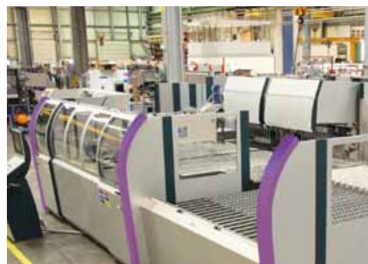
Гнутые облицовочные стойки обеспечивают здесь безопасность эксплуатации станков для обработки листовой стали.
